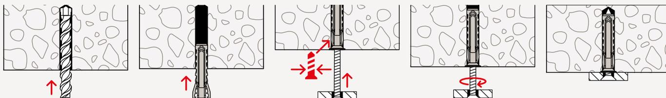
Per una corretta installazione, la lunghezza della vite deve essere pari almeno a: lunghezza del tassello + spessore dell'oggetto da fissare + diametro della vite, calcolata secondo il seguente schema.
